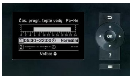
Nová regulace Vitotronic – jasné zobrazení spínacích časů.
